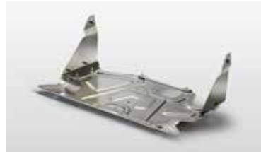
Motor Alt Muhafaza (Alüminyum)
